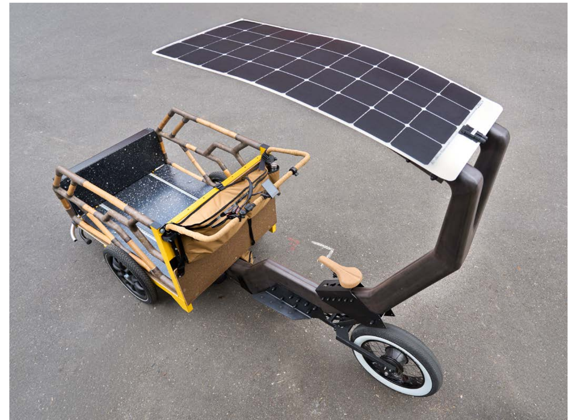
Panneau solaire grand format, lin, bambou, caisse en polymère recyclé et acier
